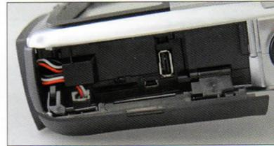
Die Erhöhung der Betriebsdauer auf mindestens sechs Stunden wurde erreicht durch Reduktion des Stromverbrauches bei gleichzeitiger Erhöhung der Akkukapazität auf 3500 mA.
